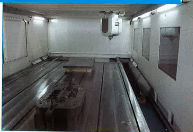
Cette KXG 45 - 23 destinée à la Chine en est au stade du déverminage avant réception. La table de travail de 4,7 x 2,5 m est conséquente et permet de charger plusieurs bruts si besoin, jusque 25 t. Cette 5 axes double Gantry à moteurs linéaires est un des best-sellers de la marque.
